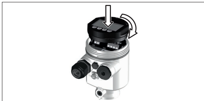
Fig. 7: Montage du module d'affichage et de réglage dans le boîtier à chambre unique se trouvant dans le compartiment de l'électronique
