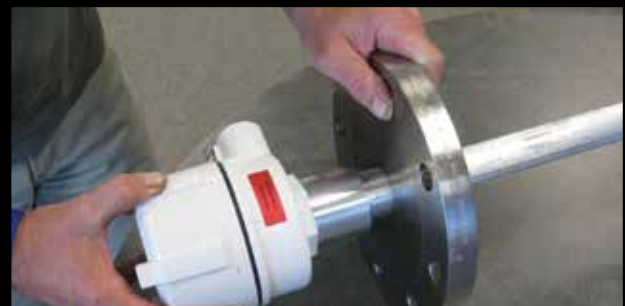
El rotativo puede ser montado atornillandolo en el cople o plato de montaje entonces.
